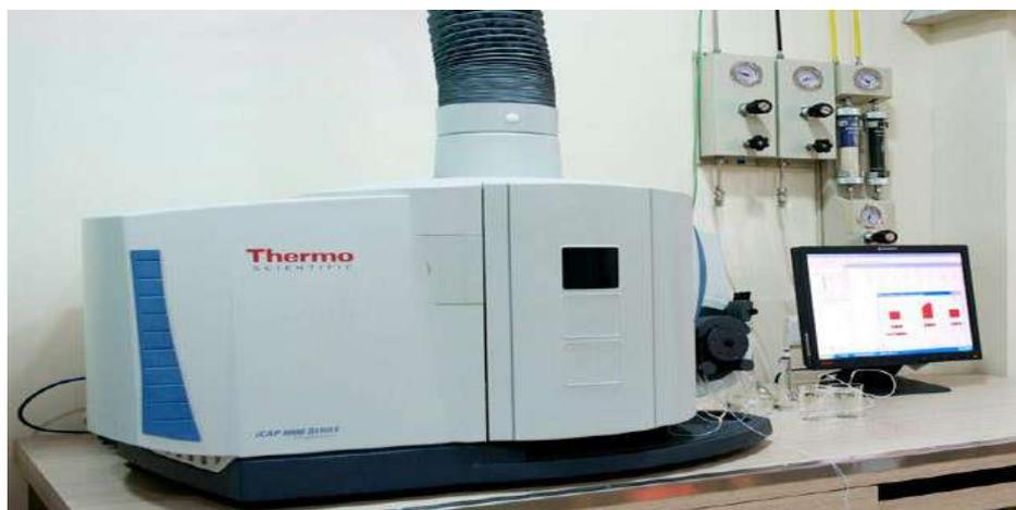
جهاز قياس العناصر بالبلازما (ICP)
